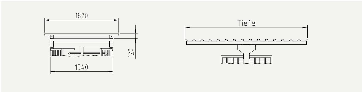
**Dach D2** – mit Trapezblechabdeckung, Dachrandprofil und Wasserablauf
